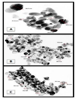
Fig. 2 TEM images of nanoparticles A) Ag , B) TiO<sub>2</sub>, C) CuO
